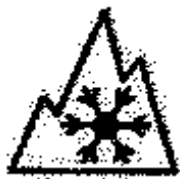
Рисунок 5.1. Маркировка, наносимая на зимнюю шину
